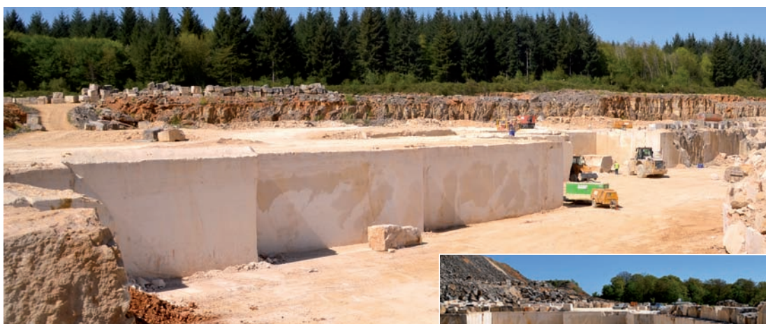
La carrière de pierre de Magny, avec des fronts de taille de plus de 6 m de haut. Le sciage à contre-passe donne la fameuse qualité Magny Le Louvre.
