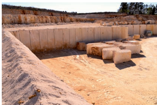
La carrière de pierre de Magny, avec des fronts de taille de plus de 6 m de haut. Le sciage à contre-passe donne la fameuse qualité Magny Le Louvre.
